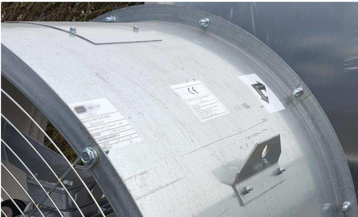
Ventilator mit Hebeösen
