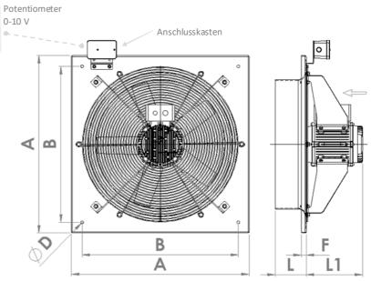
Die in 6 Größen und 11 Modellen erhältliche Baureihe DA EC bietet Durchmesser von 250 mm bis 500 mm, die einen breiten Leistungsbereich abdecken (siehe "Betriebsbereiche"). Die Motoren sind für Geschwindigkeiten von 500 bis 1500 U/min od. von 1000 bis 3000 U/min erhältlich.
